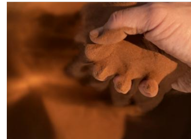
Feinkörnige Asche aus der Staubfeuerung
