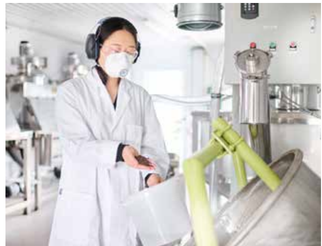
Kontrolle der Korngröße der Düngergranulate in der Pontes Pabuli-Versuchsanlage am Standort der Veolia Klärschlammverwertung Deutschland GmbH (VKD). © Veolia GmbH
